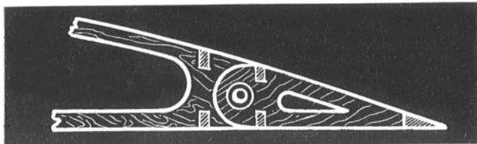
Fig. 61 - Coda di centina con cerniera per alettoni.
