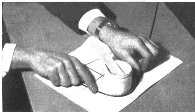
Fig. 77 - Facilita la curvatura di un tondino la pressione su un corpo cilindrico.
