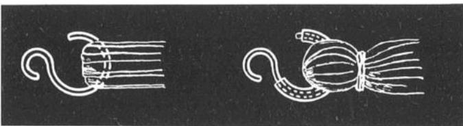
Fig. 131 - Occorre infilare un tubetto di gomma sul gancio e legare la matassa per ottenere un fissaggio perfetto.
