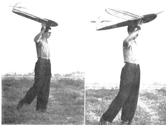
Fig. 149 - Si deve provare il volo planato di un aereo-veleggiatore, ma le posizioni assunte da questo aeromodellista sono entrambe errate, nel primo caso il modello è troppo picchiato, nel secondo caso è troppo cabrato.
