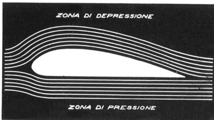
Fig. 2 - Pressione e depressione intorno ad un profilo alare.
