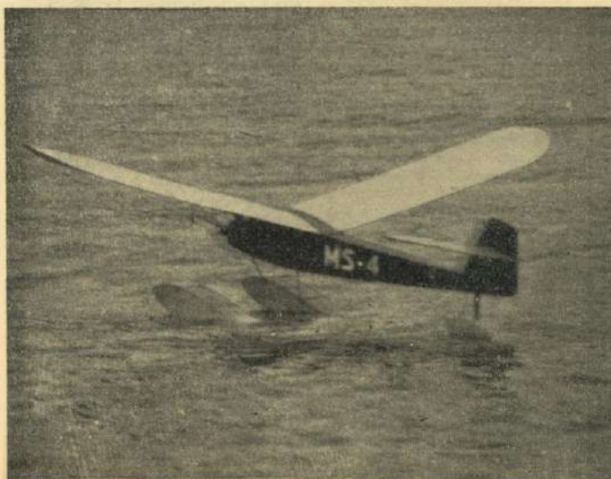
Il modello in acqua. Notare quanto sono poco immersi i galleggianti.
