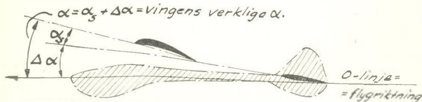
Vi sänker alltså redan på ritningen kroppens vinkel \Delta\alpha^\circ från den vinkel stabilisatorn aues flyga i, och beräknar anfallsvinkelskillnaden vinge—stabilisator ( \alpha_s ) så, att \alpha_s + \Delta\alpha blir den anfallsvinkel vingen bör ha i glidflykten.
