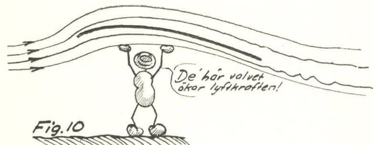
En våld platta följer luftströmmen bättre och avböjer den mera nedåt. Lyftkraften blir större i förhållande till motståndet än för plan platta.
