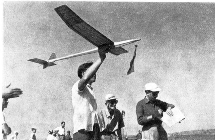
mativa, a seconda del tipo di modello, salvo a variarla in fase di messa a punto, ove si renda necessario. Per i modelli veleggiatori è sufficiente una superficie pari al 5-6% di quella alare; per i motomodelli il 7-8%, e per i modelli ad elastico il 10-12%.
