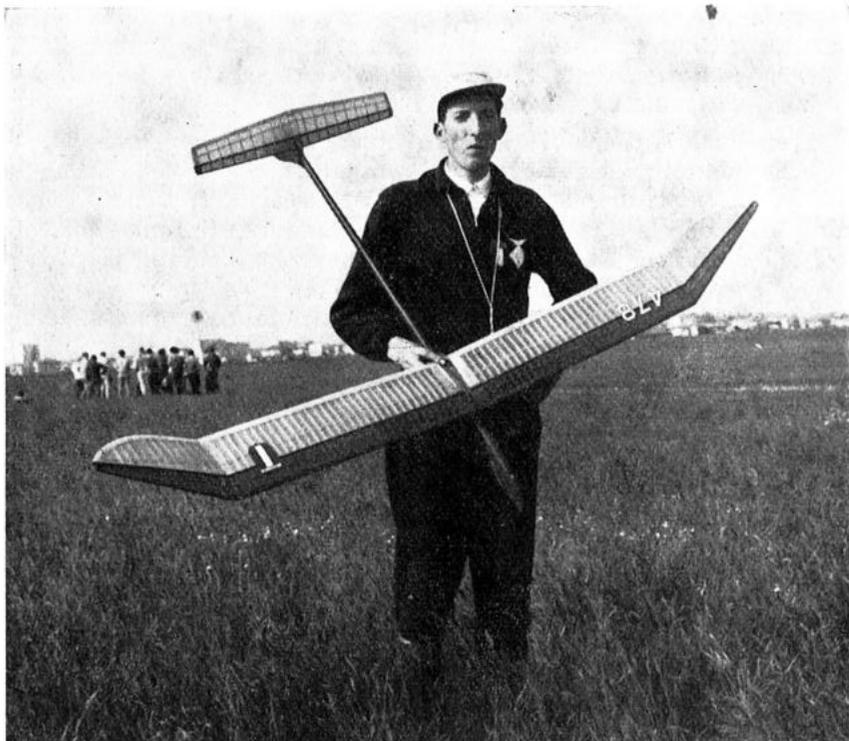
Osservare la perfetta rifinitura di questo modello veleggiatore, con fusoliera in balsa stuccato. Notare il piano di coda in posizione di antitermica.
