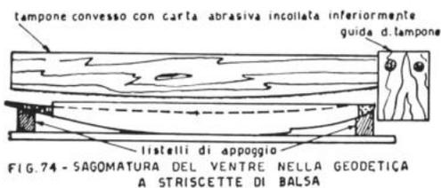
Per evitare questi inconvenienti, ed avere la massima esattezza di riproduzione del profilo, alcuni aeromodellisti, come Murari, adottano un sistema assai preciso, ma che richiede una certa attrezzatura. Si tratta di realizzare la struttura con tutte striscette di balsa rettangolari, di spessore leggermente maggiore di quello del profilo, tagliate ed incollate agli incroci, che possono essere irrobustiti con dei triangolini di balsa. Ad essiccamento avvenuto, si procede al-
