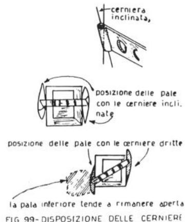
FIG. 99-DISPOSIZIONE DELLE CERNIERE
