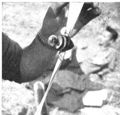
Un'elica a passo variabile a terra, del tipo illustrato in fig. 101.
