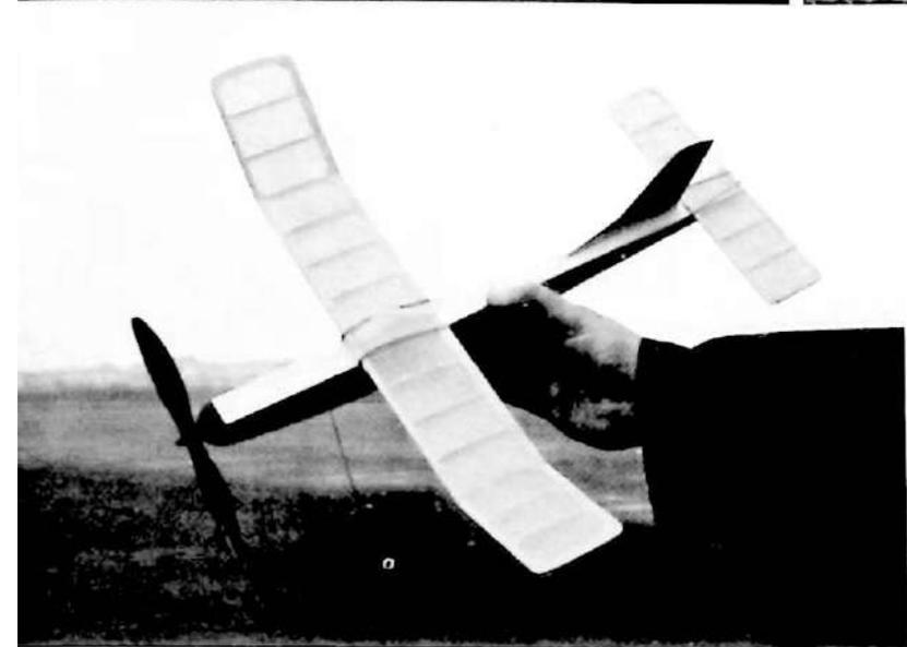
Tre viste del modello completo. Notare la cabinetta trasparente sull'ala, la posizione degli elastici di fissaggio dell'ala e del piano di coda e le strisce di carta colorata per rifinitura.
