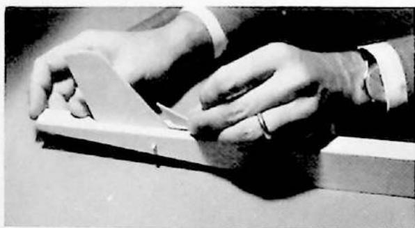
Dopo averla cosparsa di collante, infilate prima la parte posteriore della deriva e poi quella anteriore, curando che, durante l'incollaggio, si mantengano verticali. Ripassate poi un filo di collante lungo la giunzione.
