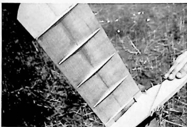
Dettaglio della struttura alare. Si notino le false centine e la linea di giunzione delle due tavolette. Si noti anche come l'ala poggia sugli appositi pianetti, fermata con un paio di anelli elastici fissati agli spinotti. Potete vedere anche la posizione degli spinotti per l'aggancio del cavo di traino.
