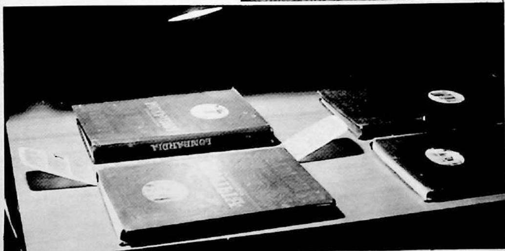
Lasciate asciugare la carta tenendo la parte centrale dell'ala ed il piano di coda su un piano di marmo o formica, con dei pesi sui bordi (libri o altro). Quindi date due mani di collante diluito (una parte di collante e due di solvente alla nitro) con un pennello molto morbido (di pelo di castoro). Dopo ogni mano rimettete i pezzi sotto peso, dopo averli fatti asciugare per due-tre minuti, per evitare che si attacchino al piano.
