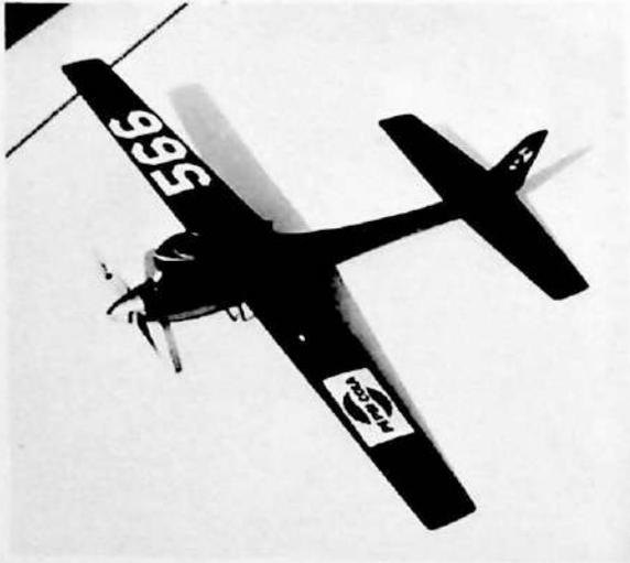
Un aeromodello da velocità in volo circolare, con motore da 2,5 cc. Questi modelli sono in grado di superare i 250 kmh.
