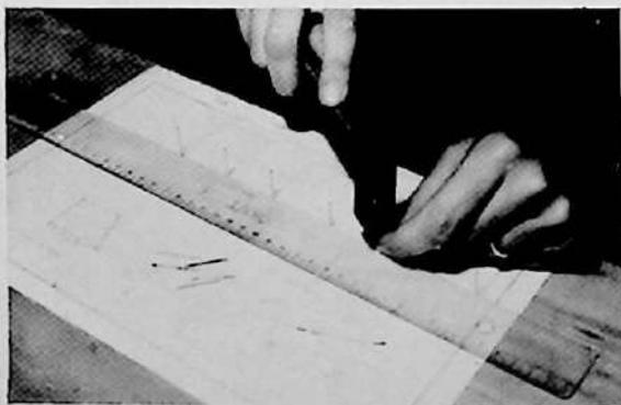
**Nel montaggio occorre tenere presente che i sottili listelli potrebbero facilmente risultare ondulati. Pertanto disponete gli spilli esterni al contorno ben allineati, mediante una riga.**
