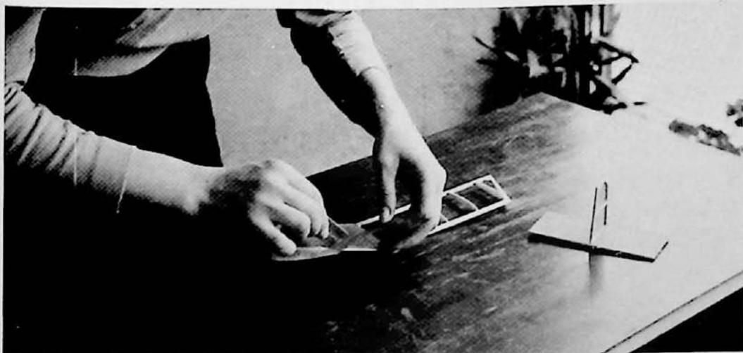
I piani di coda sono già ricoperti, e si procede alla ricopertura dell'ala, che viene effettuata in due pezzi, sovrapposti sulla centina centrale, perché altrimenti la forma a diedro provocherebbe delle grinze. Il contorno eccedente viene rifilato con una lametta.
