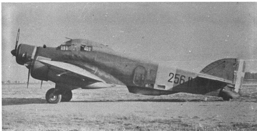
91- Un S.79 della 256° Sq. Aerosiluranti sull'aeroporto di Biserta (Algeria). Anche questo aeroplano, come confermato da un componente dell'equipaggio, è ricondizionato con tinteggiatura mimetica in grigio; solo la parte bassa della fusoliera, dal portello lungo tutto il bordo d'attacco con l'ala, non sembra completamente ricoperta dal nuovo colore.
