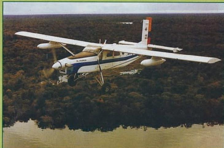
Pilatus-Porter PC-6, de fabricación Suiza. Capacidad: nueve pasajeros, capacidad de carga: 900 kilos, velocidad crucero: 120 mph, techo: 25.600 pies.
