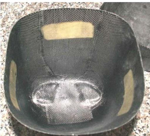
**Naca motore vista di profilo e il suo interno:** Vengono praticati: l'apertura nella parte inferiore per l'uscita della testa motore, i fori anteriori per presa d'aria e uscita albero motore, ed i tre fori per le viti di fissaggio alla fusoliera. In questi tre punti applico in fase di stampaggio delle “pezze” di tessuto di Kevlar.
