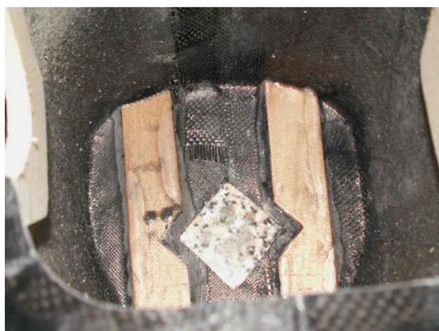
**Corpo della fusoliera vista dall'ordinata parafiamma (3) all'interno della quale sono stati inseriti, in fase di stampaggio, degli inserti in compensato di faggio per il fissaggio del castello motore**
