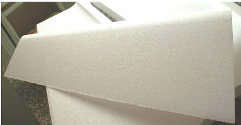
**Anima dell'ala in polistirolo con i due gusci che serviranno a pressare il balsa sul guscio durante l'essiccazione della resina**
