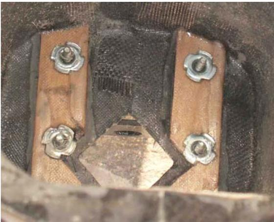
Stesse viste con griffe per il fissaggio del castello motore e il cassetto in balsa per contenere il serbatoio
