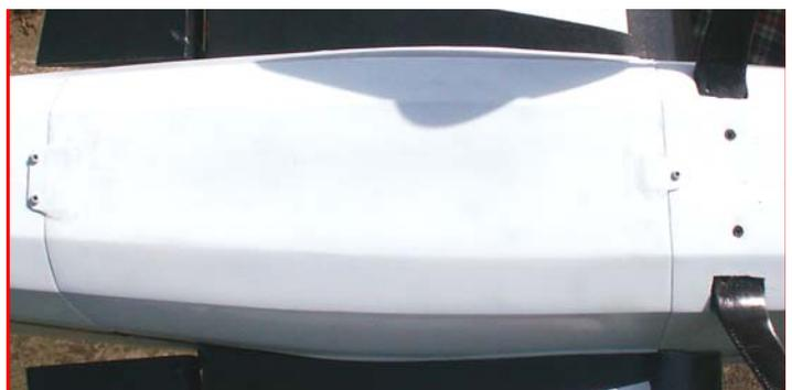
Viti e piastrine per il fissaggio della pancia. Si vedono anche le viti per il fissaggio del carrello
