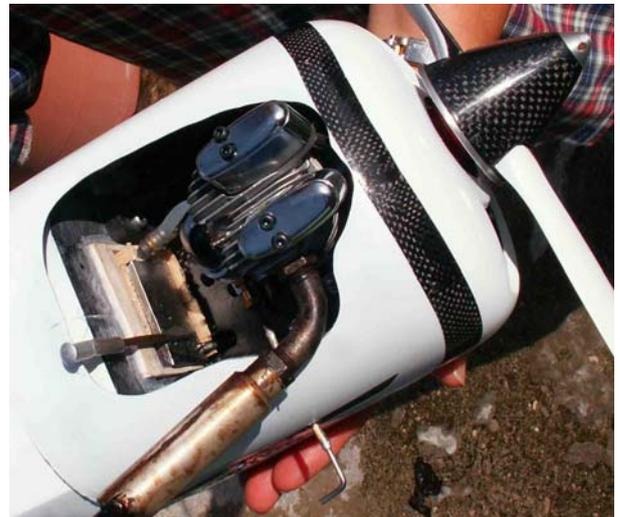
Adatto la *pancia* della fusoliera al profilo dell'ala e la rendo removibile incollando due piastrine sulla *pancia* e fissando quest'ultima alla fusoliera con viti autofilettanti. Passo quindi, all'incollaggio della capottina pilota trasparente con epoxi, dopo averla rifilata ed adattata.
