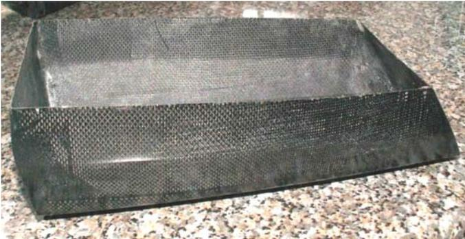
La “pancia” come esce da stampo; viene in seguito adattata al profilo alare, e fissata alla fusoliera in maniera fissa o rimovibile, a piacere
