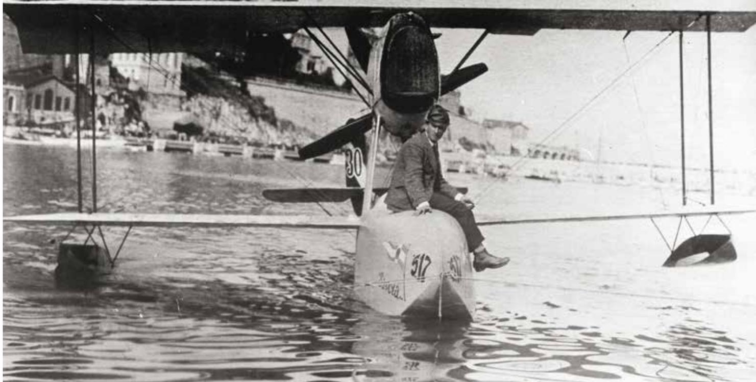
**Sviluppato proprio per la Schneider, l'S.17, qui alla fonda a Monaco, aveva solo 7,7 m di apertura alare e raggiungeva i 190 km/h. Da esso deriverà l'S.19**
