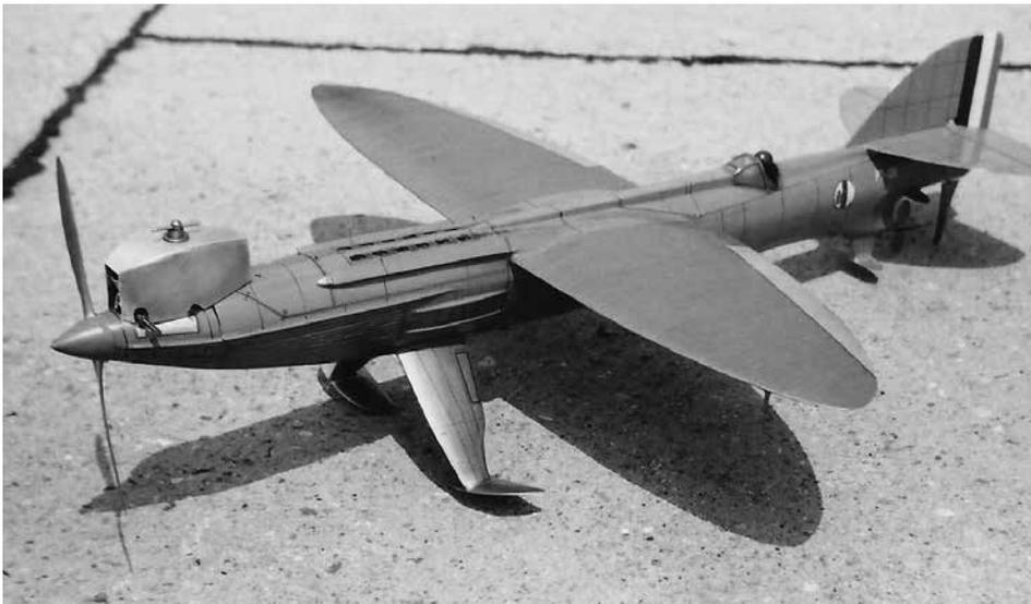
Foto del Pegna P.C. 7 appena completato. Da notare la capottatura profilata sopra la testa del motore Supertigre G.20 diesel da 2,5 cc. L'elica è quella da figura per la valutazione a terra. In volo, veniva sostituita da un'elica adatta al motore.
