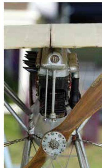
**Il monocilindrico** OPS è stato inserito nel simulacro motore, gli scarichi sulla sinistra sono funzionanti
