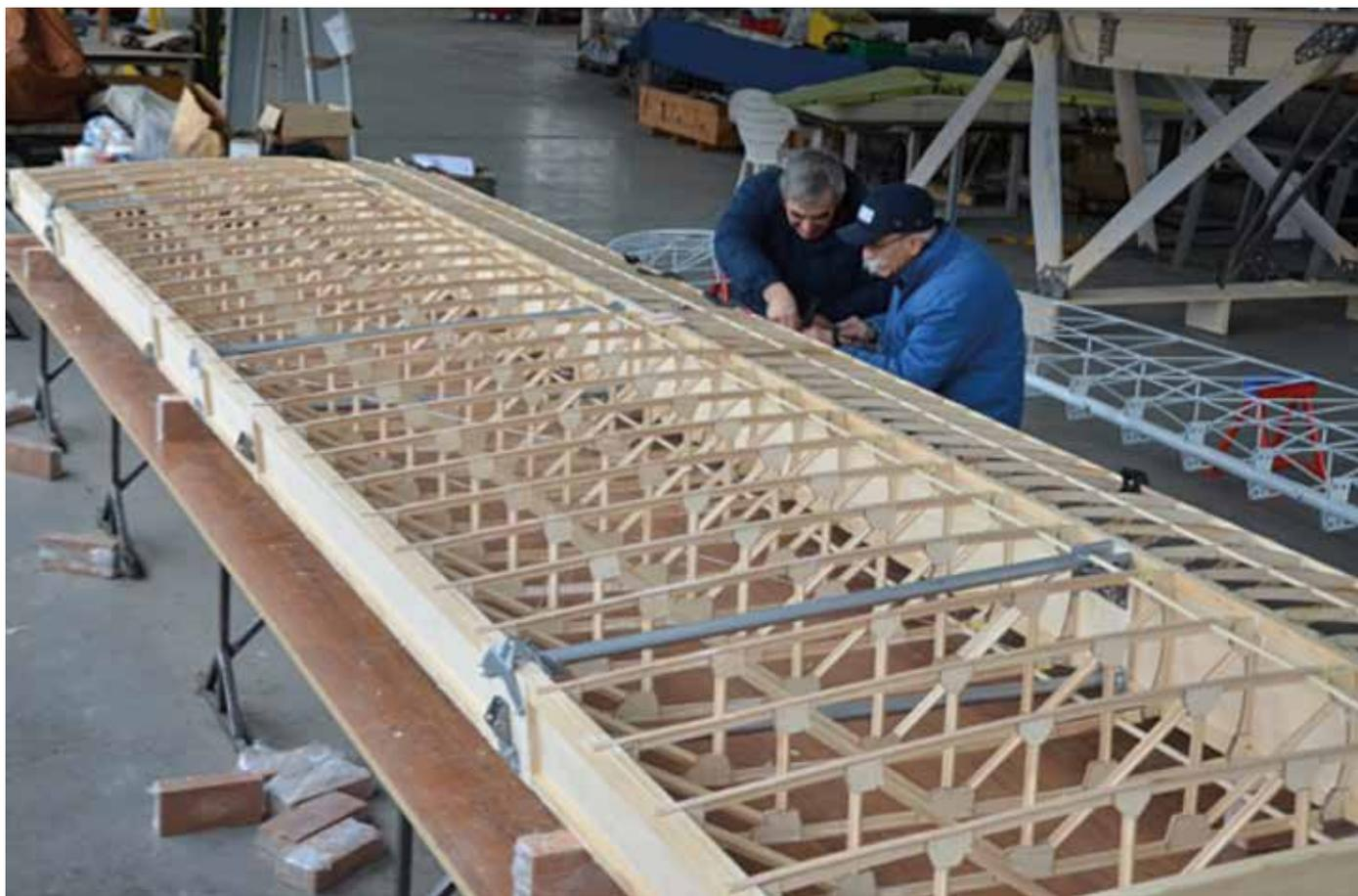
Le dimensioni e la complessità del piano di coda sono ben visibili in questa foto. Le centine sono costituite da strutture di tipo reticolare.
