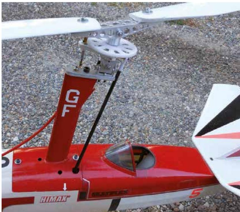
**Il rotore** in versione bipala con prerotazione: la testa è in alluminio montata su un perno
