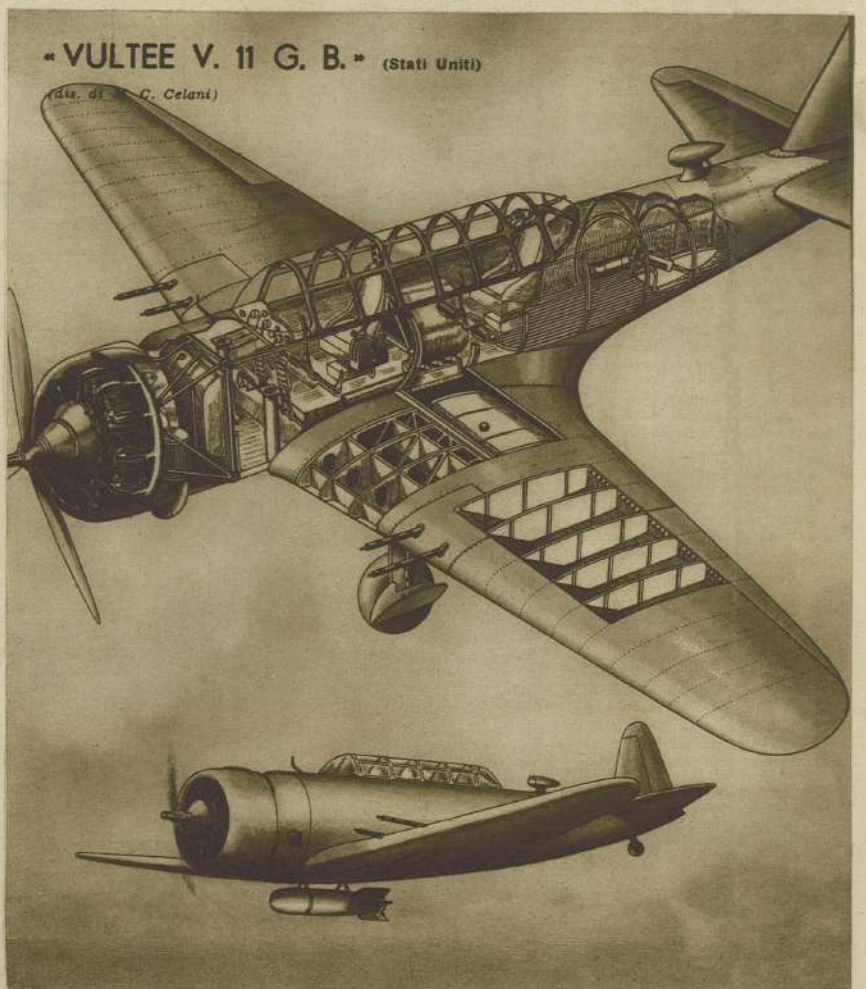
Apparecchio monomotore biposto da combattimento e da bombardamento, interamente metallico, è munito di un motore «Wright Cyclone» da 850 cv.; peso, in ordine di volo, 4.500-5.000 kg.; armato di quattro mitragliatrici fisse sulle ali, una mitragliatrice posteriore brandeggiabile dall'abitacolo dei piloti ed un'altra nella fusoliera e volta verso il basso; può portare dieci bombe da 120 libbre oppure tre da 285, due da 625 oppure una da 1.135 libbre; larghezza m. 15,25; lunghezza m. 11,42; altezza m. 3,05; superficie mq. 35,67; velocità kmh. 376; autonomia 1.700-3.400 km.; fusoliera a guscio di sezione ellittica fino a 3/4 della fusoliera e circolare per il rimanente; carrello retrattile.
