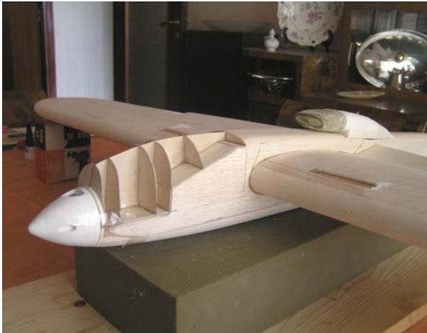
Preparazione del “maschio” per lo stampo della carenatura motore in resina
