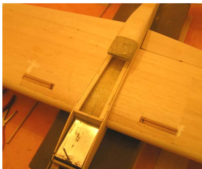
La presa d'aria inferiore in resina montata in fusoliera
