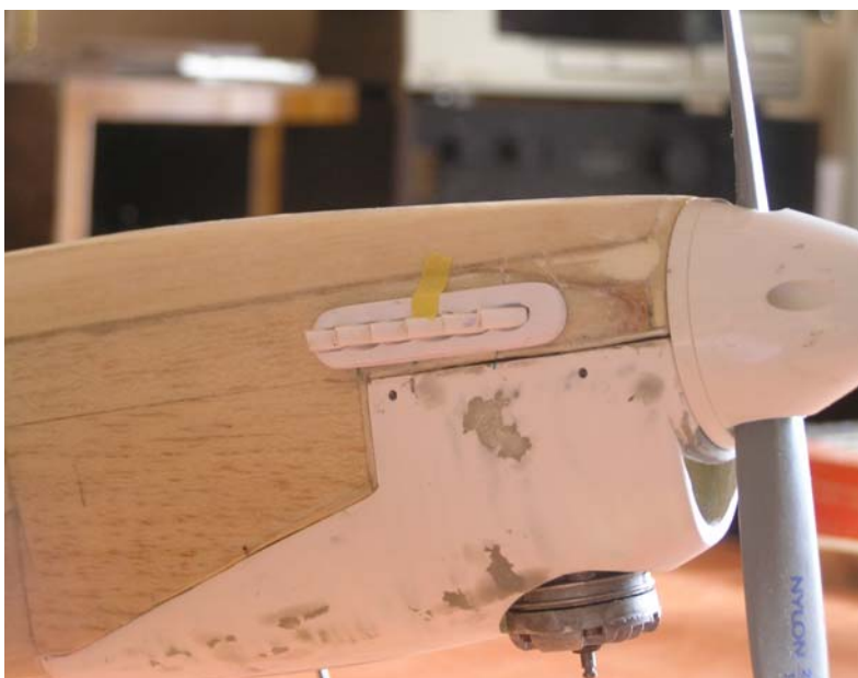
La carenatura montata. Si notano i finti scarichi autocostruiti in ABS molto più realistici di quelli del kit
