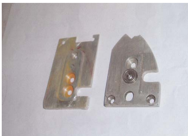
Foto 4 e 4bis: I supporti in alluminio avvitati alle centine e che sostengono le viti senza fine, il motore e gli ingranaggi
