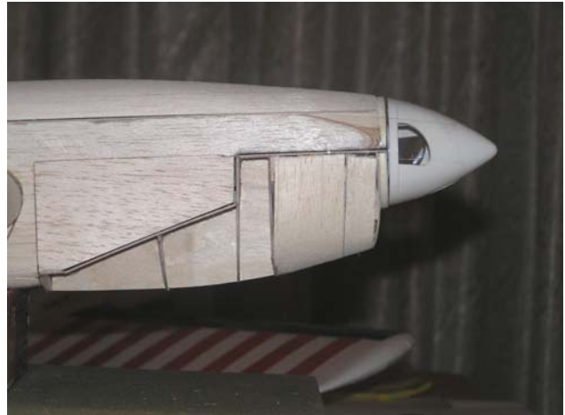
Riempimento tra le dime con blocchi di balsa
