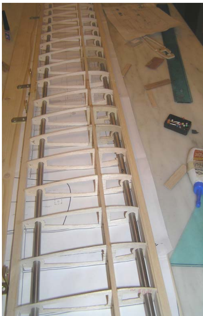
L'ala in costruzione sullo scaletto di montaggio che è stato oggetto di un articolo sul Notiziario di Volo Vincolato
