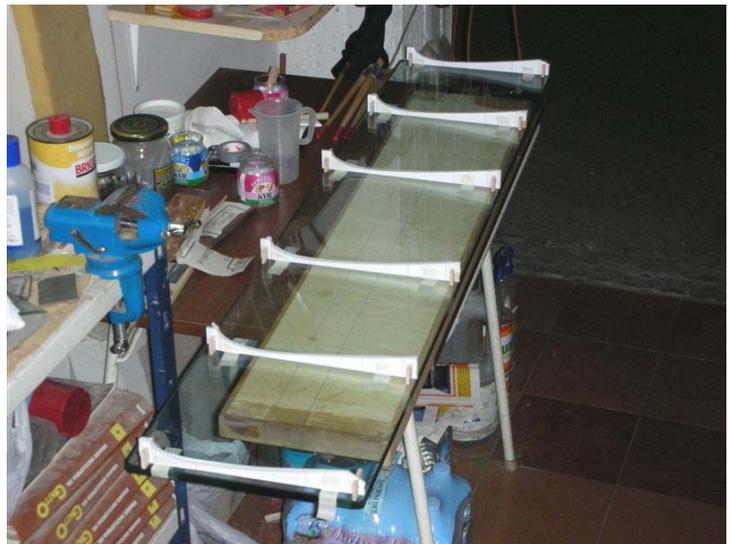
**Lo scaletto è fatto usando il ventre di 6 centine, sono in balsa duro da 3 mm, incollate al piano di vetro da 12 mm con adesivo di carta. La corda di ogni centina è quella effettiva misurata dal disegno. Dopo ogni mano di vernice, tre prima della ricopertura in polyspan, lascio asciugare 24 ore sotto peso. In questo caso posta pubblicitaria!**
