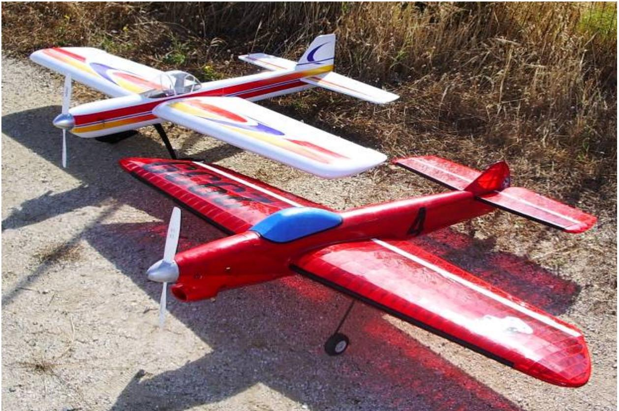
Jatsenko indica un peso ottimale di 1620/1640 gr, ovviamente gli esemplari smontabili pesano di più), che dà un carico alare di 38,6 gr/dm quadro; il Benny 4 ha circa 40 dm quadri e pesa 1560gr, pari ad un carico alare di circa 39 gr/dm quadro. Questo significa che la capacità di girare stretto e fare angoli secchi non dipende dal carico alare.
