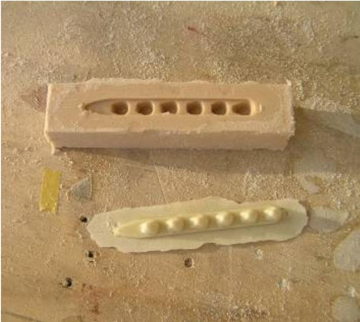
Anche il finto scarico del motore è stato ricostruito: ecco lo stampo in gomma siliconica ed il pezzo in resina. Nelle 2 foto in basso: il Curtiss P40 al termine del restauro.
