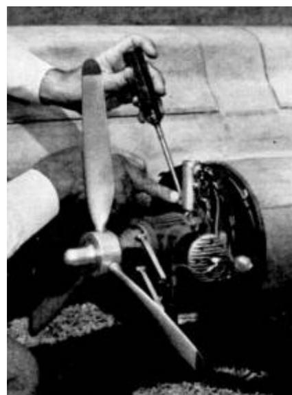
Si regola la carburazione di un bicilindrico. Come si vede, i motori erano tutti *spark*.
