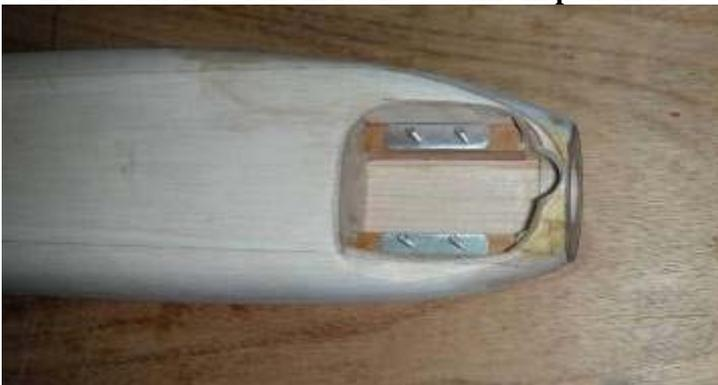
**Particolare del vano motore: si vedono le piastrine di appoggio in alluminio e i prigionieri per il fissaggio del motore**
