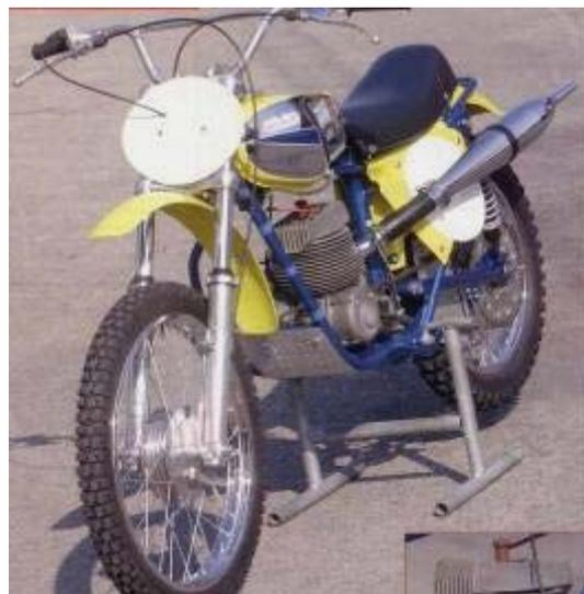
**Della seconda metà degli anni '60, una splendida MULLER da cross con scarico a risonanza. Di rilievo, la luce di scarico posta in posizione posteriore che determina un percorso rettilineo dei gas di scarico. L'aspirazione invece era sul lato destro con valvola a disco rotante.**
