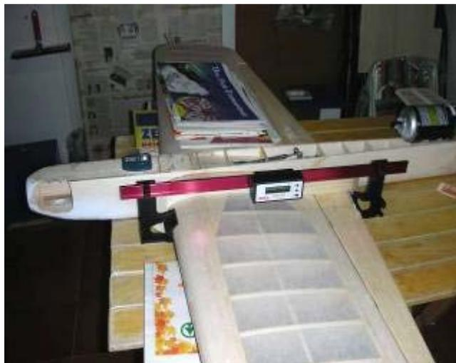
**Il montaggio dell'ala e del piano di coda è curato con un misuratore di incidenza digitale**
