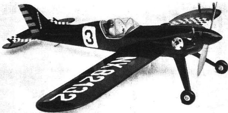
**Ali** — Di costruzione normale, solidali con la fusoliera date le minime dimensioni del modello, sono rivestite in seta; i passacavi sono posti sulla estremità sinistra.
