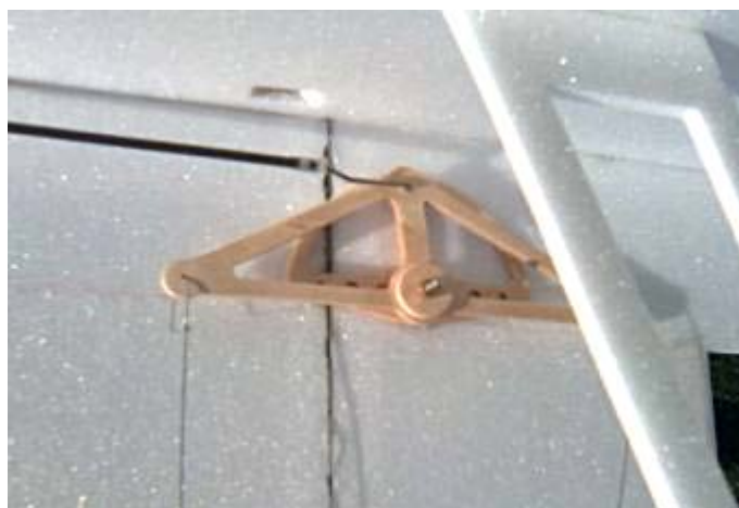
Particolare del carrello e della squadretta di comando
