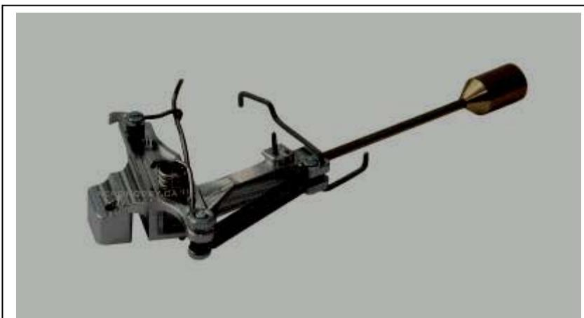
**Foto 23: Shutoff 2013 lituano di A. Rastenis: si noti la seconda molla montata al centro dello shutoff stesso ed il piccolo uncino in fondo per lo sgancio della molla che aziona forzatamente il braccio centrifugo, spegnendo il motore.**
