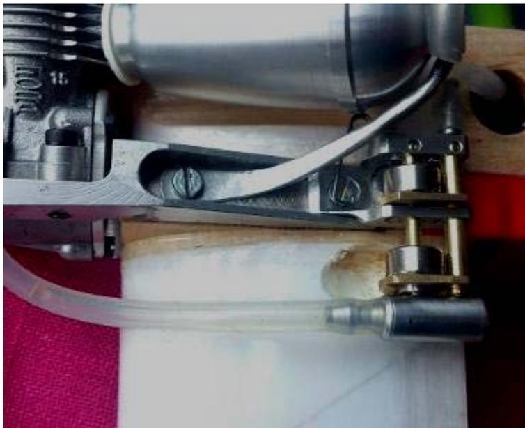
**Foto 26:** Nuovo *shutoff* del 2014 prodotto dall'olandese *Jacco De Ridder*. Si intravede l'uncino che tiene bloccata la massa col magnete per l'avviamento del motore.
