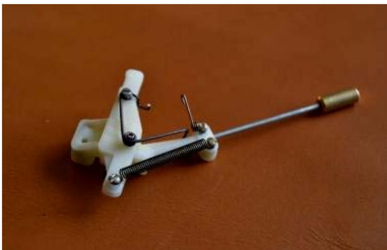
**Foto 25:** *Shutoff* 2013 ucraino: anche in questo caso è stata aggiunta una molla centrale che viene azionata dallo strattone e sgancia questa seconda molla che spinge l'asta verso l'esterno. Nella foto è in posizione per far spegnere il motore.
