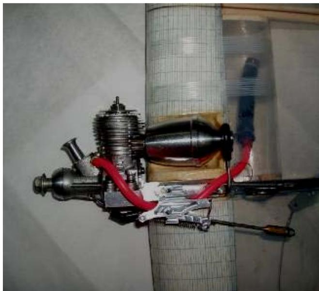
**Foto 22:** Motore *Fora* con la nuova marmitta da 6 mm. di *A. Rastenis*. Si noti anche la terza serie dello *shutoff*, sempre di *Rastenis*, montato sulla prima vite della longherina, senza la presenza dell'accessorio strizza tubicino per la messa in moto.
