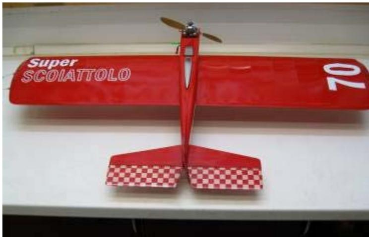
mi ricordavo che si rompeva sempre. Per comodità di lavorazione il direzionale e piano mobile sono stati montati dopo la verniciatura. Il piano mobile è stato ricoperto con carta cinese a scacchi rossi e sopra verniciato con trasparente. Dopo una sequenza di tendicarta-carteggiatura il modello era pronto per la verniciatura.
