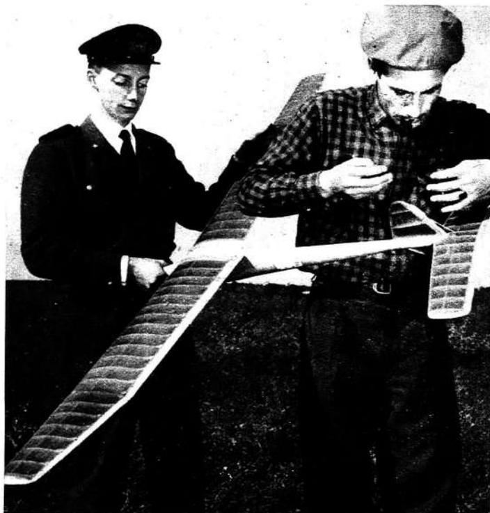
traversini in balsa semiduro 1,5x4,5; ricopertura il Silxpan leggera bianca per il dorso (compreso il tratto inferiore, verniciata con 4 mani di collante diluito e lucidata con solvente per nitrocellulosa. Il carrello è in giunco ed è fissato alla fusoliera col solito sistema a tubetto di carta.
