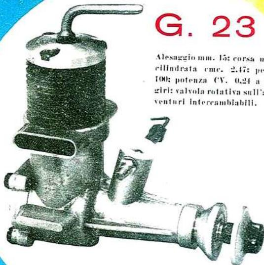
Alésaggio mm. 15; corsa mm. 14; cilindrata cme. 2,47; peso gr. 100; potenza CV. 0,24 a 13.500 giri; valvola rotativa sull'albero; venturi intercambiabili.
