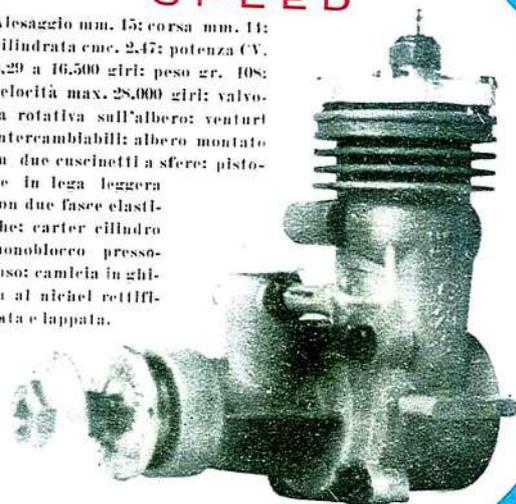
Alésaggio mm. 15; corsa mm. 14; cilindrata cme. 2,47; potenza CV. 0,29 a 16.500 giri; peso gr. 108; velocità max. 28.000 giri; valvola rotativa sull'albero; venturi intercambiabili; albero montato su due cuscinetti a sfere; pistone in lega leggera con due fasce elastiche; carter cilindro monoblocco pressofuso; camicia in ghisa al nichel rettificata e lappata.
