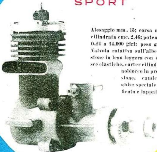
Alesaggio mm. 15; corsa mm. 14; cilindrata cmc. 2,46; potenza CV. 0,24 a 14.000 giri; peso gr. 100; Valvola rotativa sull'albero, pistone in lega leggera con due fasce elastiche, carter cilindro monoblocco in pressofusione, camicia in ghisa speciale rettificata e lappata.
