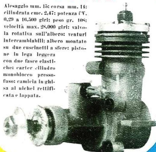
Alesaggio mm. 15; corsa mm. 14; cilindrata cmc. 2,47; potenza CV. 0,29 a 16.500 giri; peso gr. 108; velocità max. 28.000 giri; valvola rotativa sull'albero; venturi intercambiabili; albero montato su due cuscinetti a sfere; pistone in lega leggera con due fasce elastiche; carter cilindro monoblocco pressofuso; camicia in ghisa al nichel rettificata e lappata.
