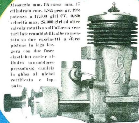
Alesaggio mm. 19; corsa mm. 17; cilindrata cmc. 4,82; peso gr. 198; potenza a 17.500 giri CV. 0,80; velocità max. 25.000 giri ed oltre; valvola rotativa sull'albero; venturi intercambiabili; albero montato su due cuscinetti a sfere; pistone in lega leggera con due fasce elastiche; carter cilindro monoblocco pressofuso; cammele in ghisa al nichel rettificata e lappata.
