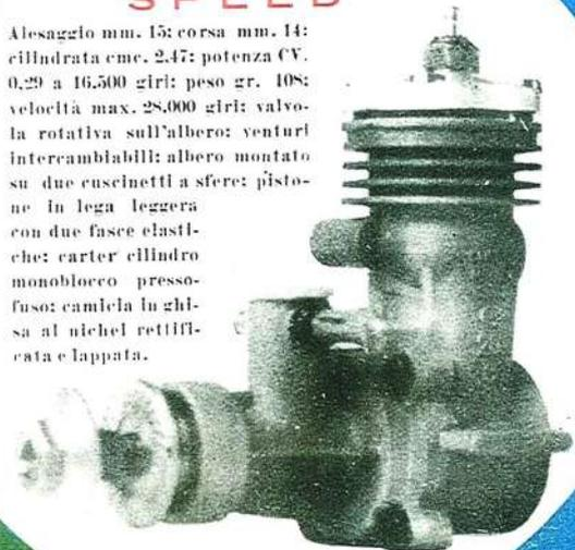
Alesaggio mm. 15; corsa mm. 14; cilindrata cmc. 2,47; potenza CV. 0,29 a 16.500 giri; peso gr. 108; velocità max. 28.000 giri; valvola rotativa sull'albero; venturi intercambiabili; albero montato su due cuscinetti a sfere; pistone in lega leggera con due fasce elastiche; carter cilindro monoblocco pressofuso; cammele in ghisa al nichel rettificata e lappata.
