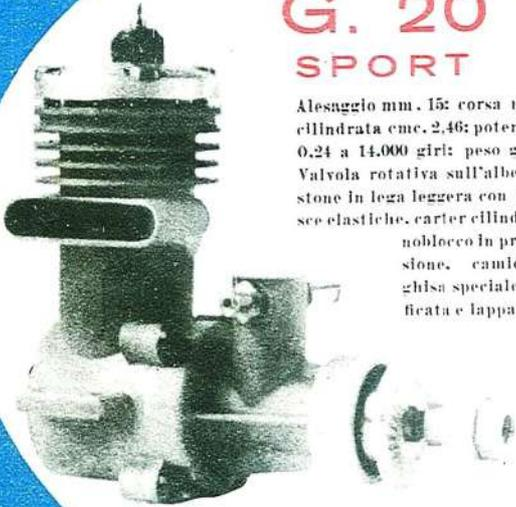
Alesaggio mm. 15; corsa mm. 14; cilindrata cmc. 2,46; potenza CV. 0,24 a 14.000 giri; peso gr. 100; Valvola rotativa sull'albero; pistone in lega leggera con due fasce elastiche; carter cilindro monoblocco in pressofusione; cammele in ghisa speciale rettificata e lappata.
