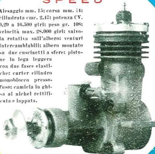
Alésaggio mm. 15; corsa mm. 14; cilindrata cmc. 2,47; potenza CV. 0,29 a 16.500 giri; peso gr. 108; velocità max. 28.000 giri; valvola rotativa sull'albero; venturi intercambiabili; albero montato su due cuscinetti a sfere; pistone in lega leggera con due fasce elastiche; carter cilindro monoblocco pressofuso; camicia in ghisa al nichel rettificata e lappata.
