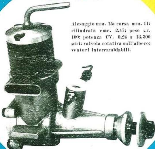
Alésaggio mm. 15; corsa mm. 14; cilindrata cmc. 2,47; peso gr. 100; potenza CV. 0,24 a 13.500 giri; valvola rotativa sull'albero; venturi intercambiabili.
