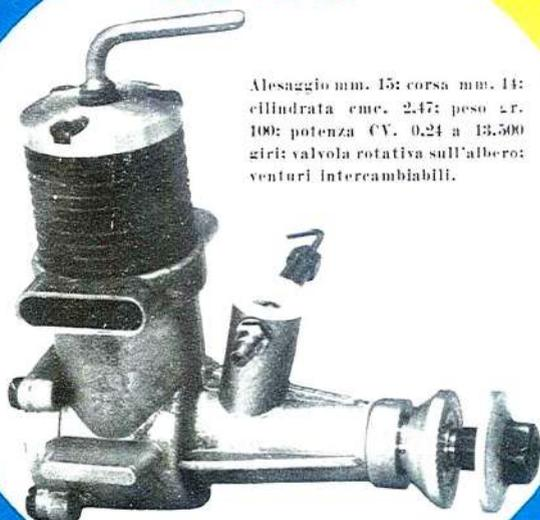
Alesaggio mm. 15; corsa mm. 14; cilindrata cmc. 2,47; peso gr. 100; potenza CV. 0,24 a 13.500 giri; valvola rotativa sull'albero; venturi intercambiabili.
