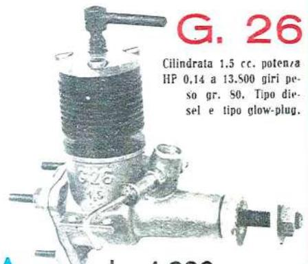
Cilindrata 1,5 cc. potenza HP 0,14 a 13.500 giri; peso gr. 80. Tipo diesel e tipo glow-plug.
