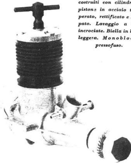
**G. 27** - Cilindrata 3,28 cc. Corsa mm. 15. Alesaggio mm 16,5. Peso gr. 175. Tipo diesel. Potenza 0,35 HP a 13.000 giri.
