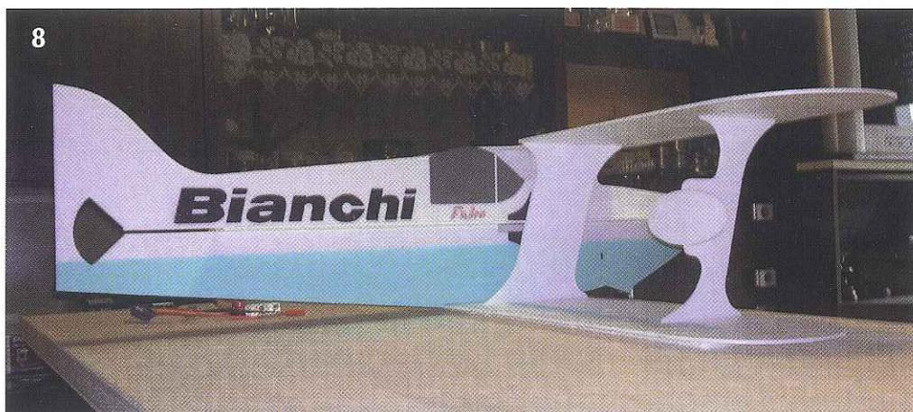
A fianco: la prima parte è ultimata. Da notare la simmetria del calettamento alare rispetto all'asse di trazione. In basso: incollaggio delle gambe tubolari per i carrelli.
