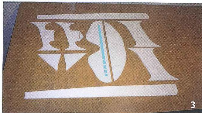
Le parti in Depron da 3 mm "tagliate" con il saldatore ed una volta finite, verniciate e pronte per il montaggio; da notare la colorazione "ciclistica".
