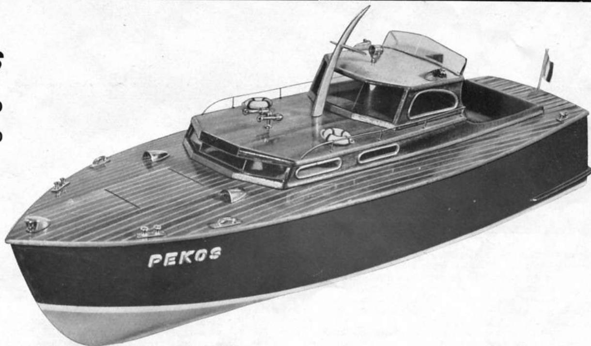
Questo moderno e razionale cruiser a cabina di medie dimensioni è adatto per motori entro bordo elettrici, alimentati con pile a secco. L'applicazione di piccoli motori a scoppio, che rendono il modello oltremodo veloce è facilitata dall'installazione del « gruppo universale Movo » ed avviatore a strappo, ciò che è consigliabile solo a chi ha già pratica di motori a scoppio.
