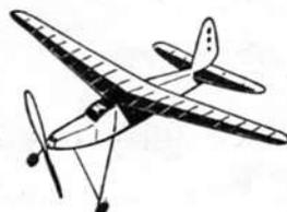
Di medie dimensioni, di piacevole linea estetica e di ottime doti di volo. Costruzione della fusoliera a traliccio. Ala rastremata di mm. 1000. Lungh. mm. 635.
