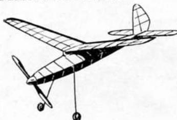
Di alto rendimento e finezza, ala parasole a pianta semiellittica, fusoliera a traliccio disposta a spigolo. Ala mm. 984 - Lunghezza mm. 820.
