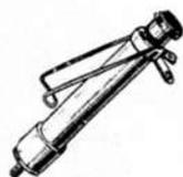
Piccolo autoscatto pneumatico per motori. Funziona strozzando il tubetto della miscela. Peso gr. 7 - Ø mm. 8 x 10.
