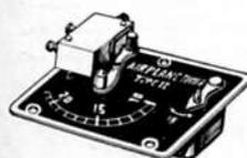
Tipo con movimento ad orologeria regolabile fino a 22 secondi. Serve per interrompere l'afflusso della miscela ai motori. E' completo di valvola di arresto con chiusura a scatto, raccordi per tubetti, quadrante graduato e base di fissaggio. Peso gr. 22 - mm. 30 x 40.
