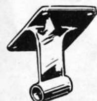
I supporti per albero elica servono per vincolare i tubi guida sul fondo dello scafo con la corretta e predisposta inclinazione.
