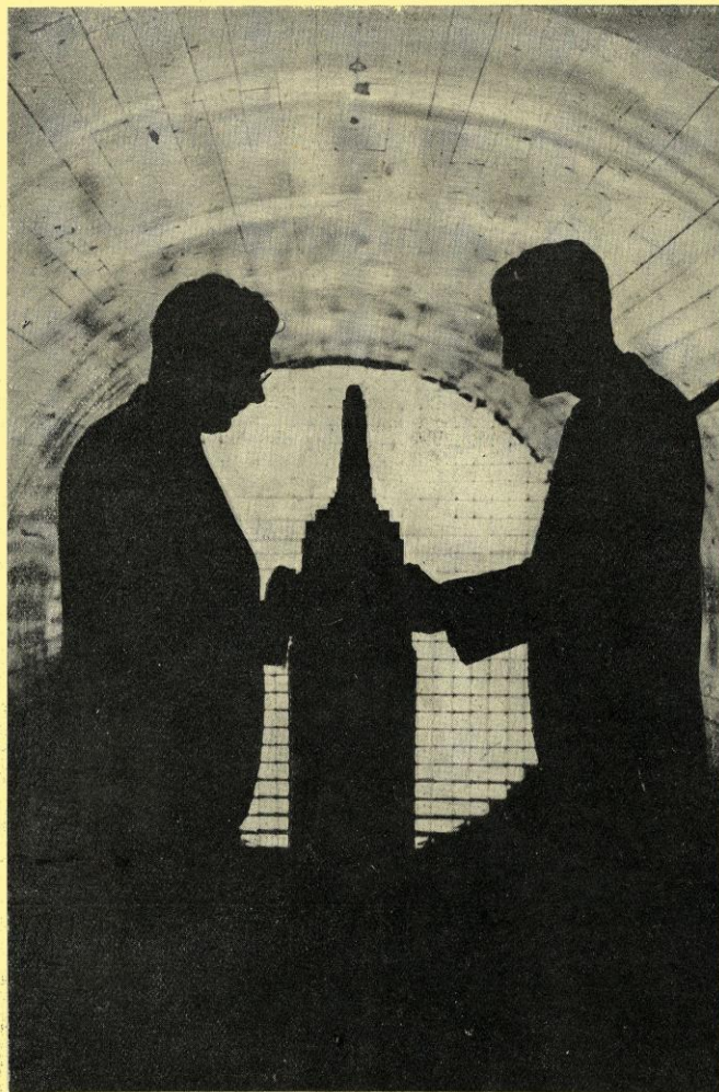
La galleria aerodinamica, oltre a servire per studiare la forma dei modelli di aeroplani allo scopo di renderla sempre più aerodinamica, viene usata, come si vede in questa fotografia, anche per provare i modelli dei grattacieli americani, sottoposti a raffiche di vento
