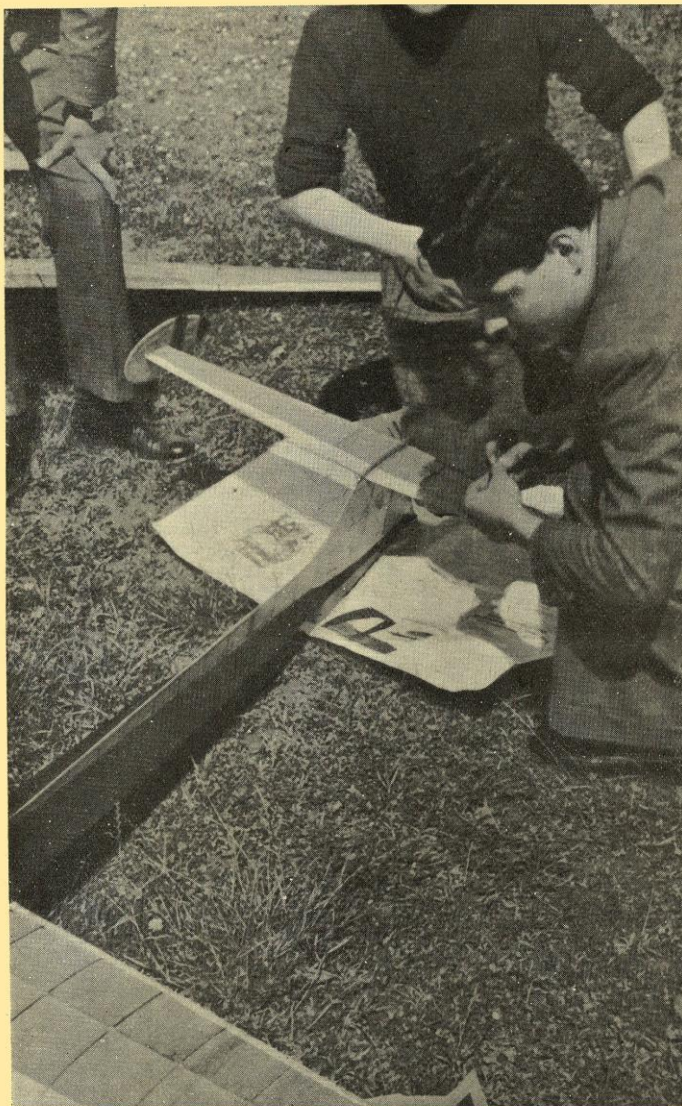
Il piano di coda del modello di Mario Rodorigo è fortemente sopraelevato rispetto all'ala, e porta gli impennaggi verticali alle estremità.
