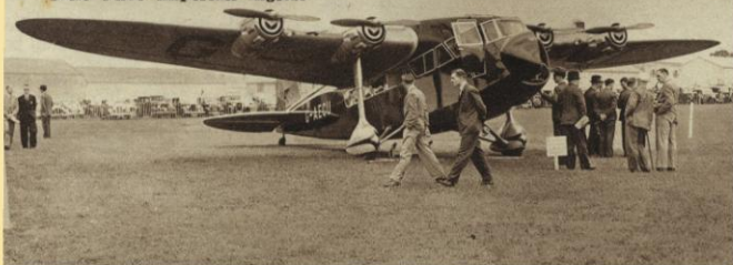
Lo «Short Scion Senior», con quattro «Pobjoy Niagara» da 90 C. V., capace di più passeggeri, che ha servito di modello per sperimentare le caratteristiche dello «Short Empire», oggi in servizio sulle linee imperiali inglesi
