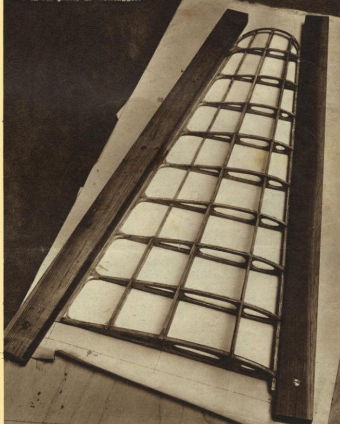
L'ossatura di una semiala fissata sul piano di montaggio.
