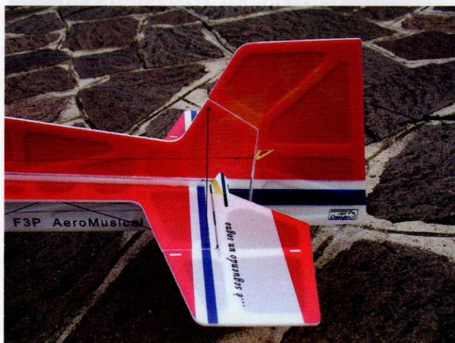
Alcuni dettagli ravvicinati del modello nei quali è possibile apprezzare da vicino l'accuratissimo lavoro di alleggerimento CNC.
