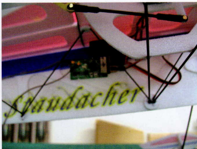
La parte inferiore della fusoliera con la ricevente e il comando dell'alettone. A destra, il finto carrello a pattino d'acciaio.
