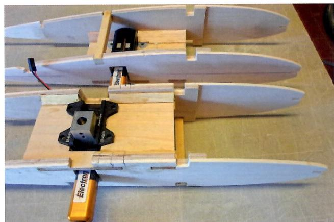
*L'installazione dei carrelli retrattili elettrici e la realizzazione del cono di coda smontabile per il trasporto. A destra, un particolare del silenziatore a barilotto autocostruito e della gamba anteriore ammortizzata del carrello in scala.*
