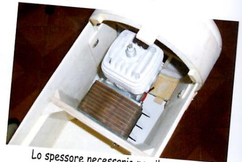
Lo spessore necessario per il corretto posizionamento del motore
