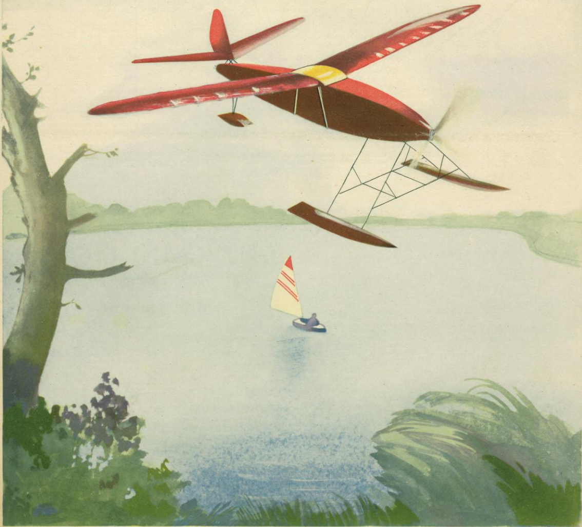
L'IDROMODELLO AD ELASTICO CON DUE ELICHE COASSIALI 'RONDINE'.
