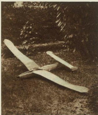
Adriano Bacchetti, costruttore di questo veleggiatore, assicura che il modello ha tre baionette verticali in alluminio e che ad ogni urto le semiali si staccano dolcemente come per magia. Dati costruttivi: Ap. 2,08, allung. 12, Eff. 25
