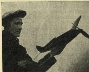
Mario Ferrarini di Pescara con il suo modello d'alta velocità. Essendo l'apparecchio sprovvisto di carrello, il costruttore ha disposto l'elica in modo che si ferma orizzontale, ma, come egli stesso ammette, i risultati sono stati scarsi «data la complicazione».
