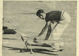
Aeromodello italiano con motore ad aria compressa. Costruzione 1935.
