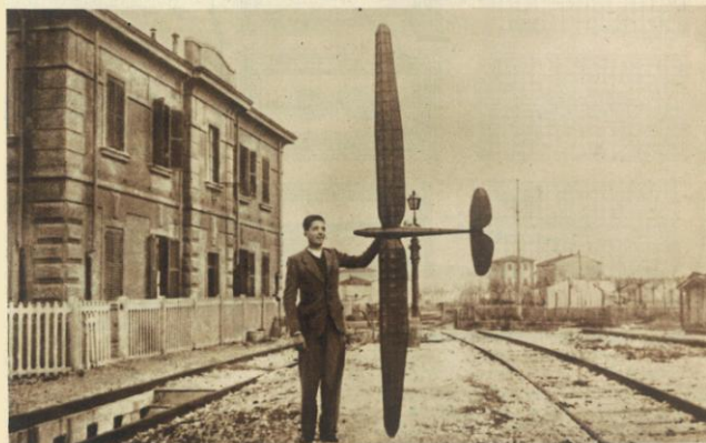
Veleggiatore ap. 3.6; lunghezza 1.35; peso gr. 1.050; carico unitario 15; superficie portante dmq. 70. Costruttore Enzo Biasci di Pontedera
