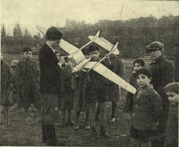
Nella fotografia in alto si vede l'ossatura di un interessante modello bimotore, riprodotto l'apparecchio inglese «Short», costruito da Elvio Tosaroni. Le eliche tripale erano a passo variabile, ed azionate ciascuna da una matassa contenuta nel tubo che rappresenta il trave laterale di fusoliera. In basso, Tosaroni sta caricando uno dei motori. Si tratta di una costruzione di molti anni fa, Tosaroni essendosi dedicato ormai quasi esclusivamente ai veleggiatori.
