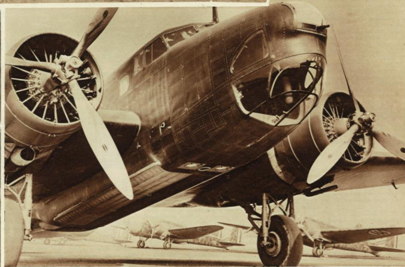
L'apparecchio riprodotto deriva direttamente dal « BR. 20 » che i nostri lettori già conoscono. Le modifiche apportate consistono in una maggiore carenatura della parte anteriore della fusoliera e in una più studiata distribuzione di aperture nella stessa, con l'evidente vantaggio di una più completa visibilità; nel posto del mitragliere anteriore, progettato più razionalmente che nel precedente tipo; in una lieve differenza di dimensioni. Inoltre, da questo tipo già modificato, la « Fiat » ha derivato ancora un tipo diverso: il « BR. 20 bis », che, essendo anche munito di motori più potenti, i nuovissimi « A. 82 », può raggiungere un massimo di velocità sensibilmente superiore a quello che può toccare il « BR. 20 M » ottenendo i 475 all'ora. Anche la capacità di carico, in questo ultimo tipo, è stata aumentata.
