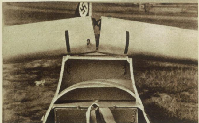
Fig. 3 - L'ala montata a metà. Gli attacchi inferiori sono già fissati
