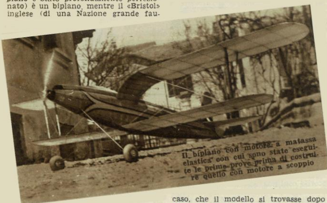
Il biplano con motore a matassa elastica con cui sono state eseguite le prime prove prima di costruire quello con motore a scoppio
