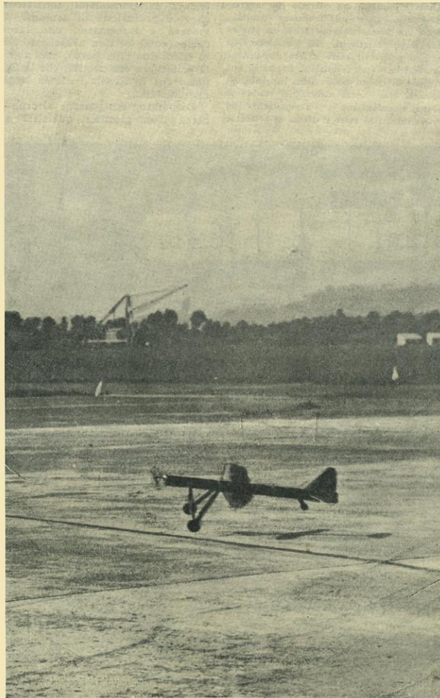
Un aeromodello con due matasse di elastico — in due tubi — e due eliche coassiali. Con questo apparecchio è stato vinto a Roma il primo premio alle gare di velocità al Concorso Nazionale 1933
