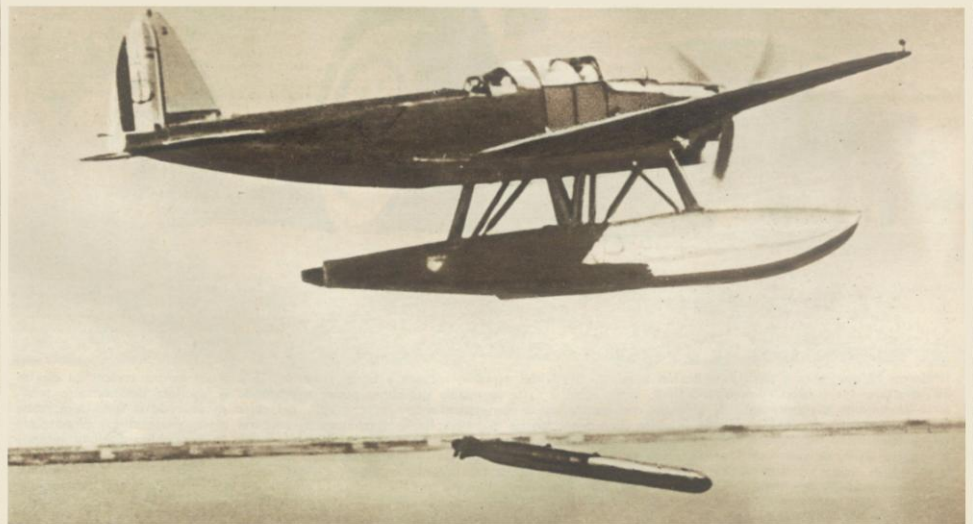
La fotografia mostra un «Latecoère 298» mentre lancia un siluro contro il bersaglio. Si tratta di un apparecchio progettato per la ricognizione ed il siluramento, che la Francia ha appena terminato di costruire in gran serie allo scopo di sostituire l'ormai anziano «Latecoère 29». Questo velivolo idrovolante triposto è costruito interamente in metallo, ed è munito di galleggianti con ammortizzatori. Il suo armamento è notevole: un motore-cannoni (arma automatica che spara attraverso il mozzo dell'elica) e tre mitragliatrici: due sulle ali, con tiro al fuori del diametro dell'elica, ed una posteriore, orientabile. Ecco le sue principali caratteristiche di volo: velocità massima 300 km/h.; soffitto 6000 metri; autonomia 1500 km. Il «Latecoère 298» è munito di un motore «Hispano-Suiza» da 835 cv.
