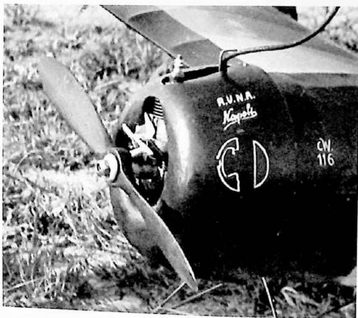
Particolare del muso dello stesso modello. Si notano le scritte di cui si parla nel testo e si intravede il motore Grazzini Giglio 10.
