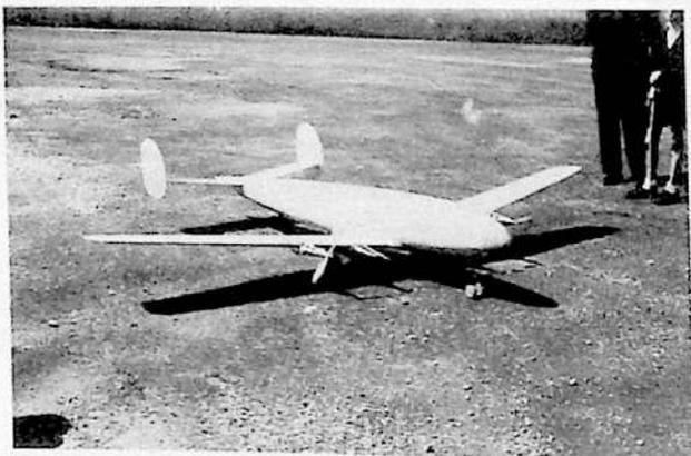
MB 308 a volo libero scala 1:5. Motore autocostruito 10 cc.
