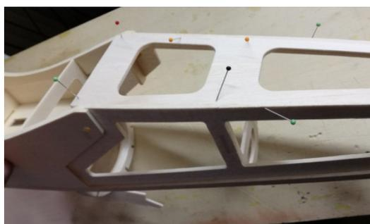
Dopo aver unito tra loro i tre pezzi componenti il fondo della fusoliera, provarlo ed adattarlo in posizione, tra i due fianchi da 3 mm.
