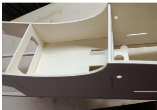
Provare gli incastri delle ordinate ( da 1 a 4) e, se necessario, adattare gli incastri.
