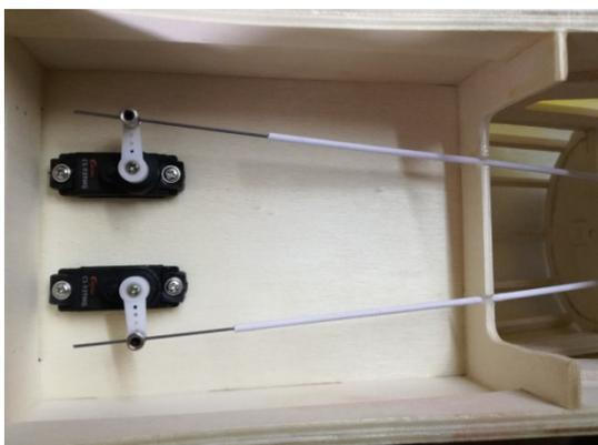
Montare i comandi usando un Bowden da 2 mm con interno in acciaio da 0,8.
