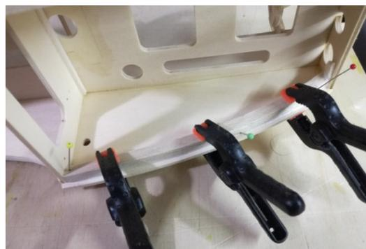
Bagnare bene e piegare i listelli triangolari in balsa tenero per adattarli alla curva del musetto fusoliera sotto, servono per creare l'appoggio del fondo fusoliera in balsa da 3 mm.
