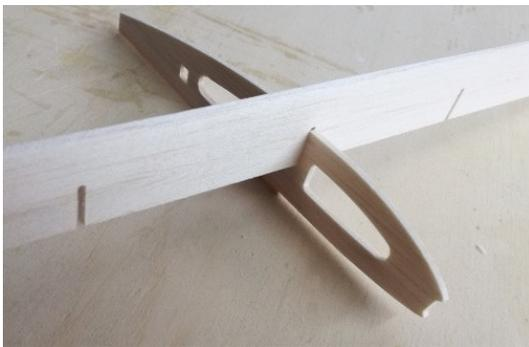
Provare gli incastri tra Centine e Longherone che devono essere precisi ma non sforzare, per evitare deformazioni e rotture dei pezzi.
