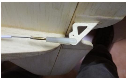
**Prima** di passare alla ricopertura, fissare i Bowden all'interno della fusoliera, alle estremità, ma anche al centro, ancorandoli ad una ordinata.
