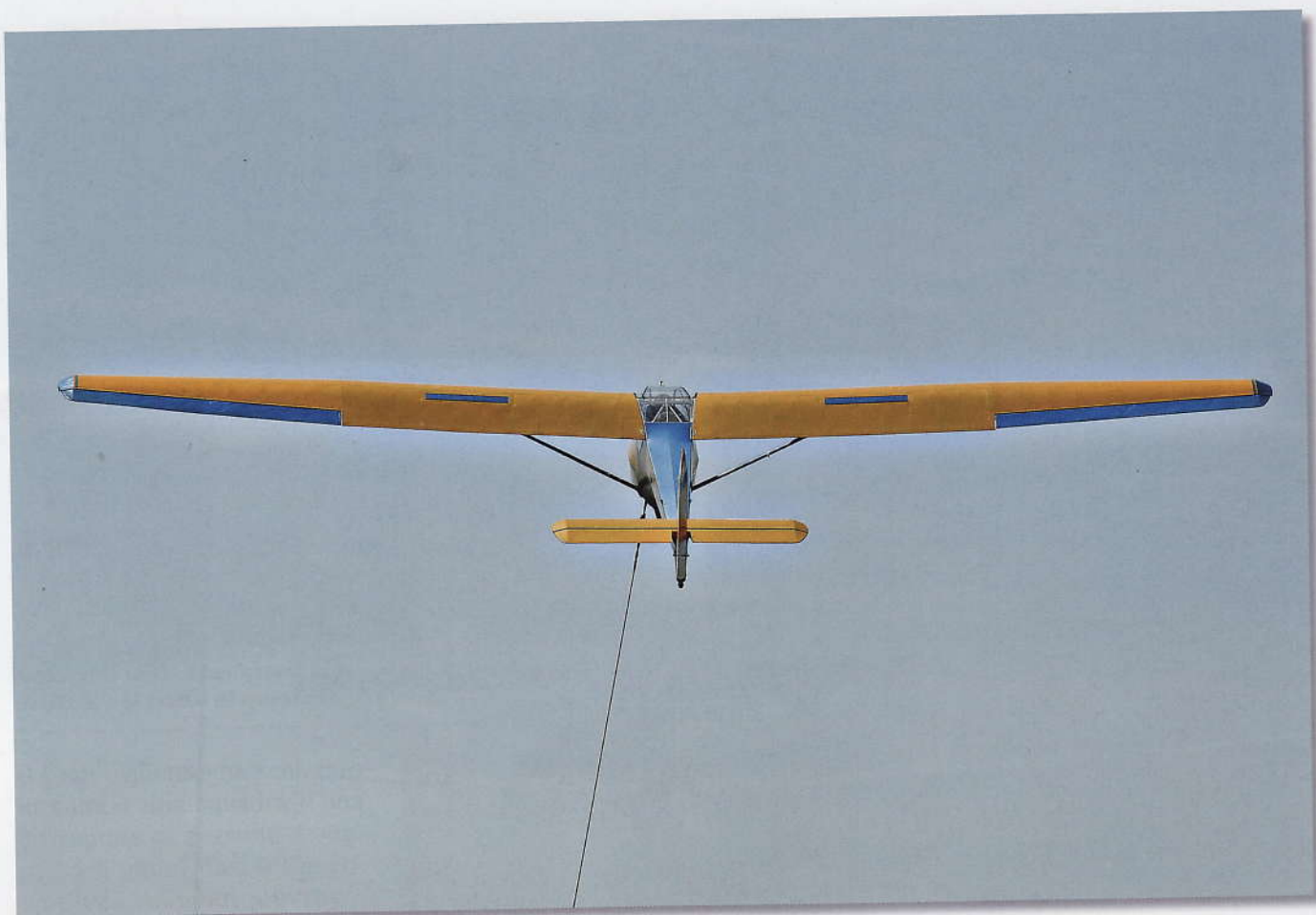
Lancio al verricello di uno Schleicher Ka-4 Rhönlerche
