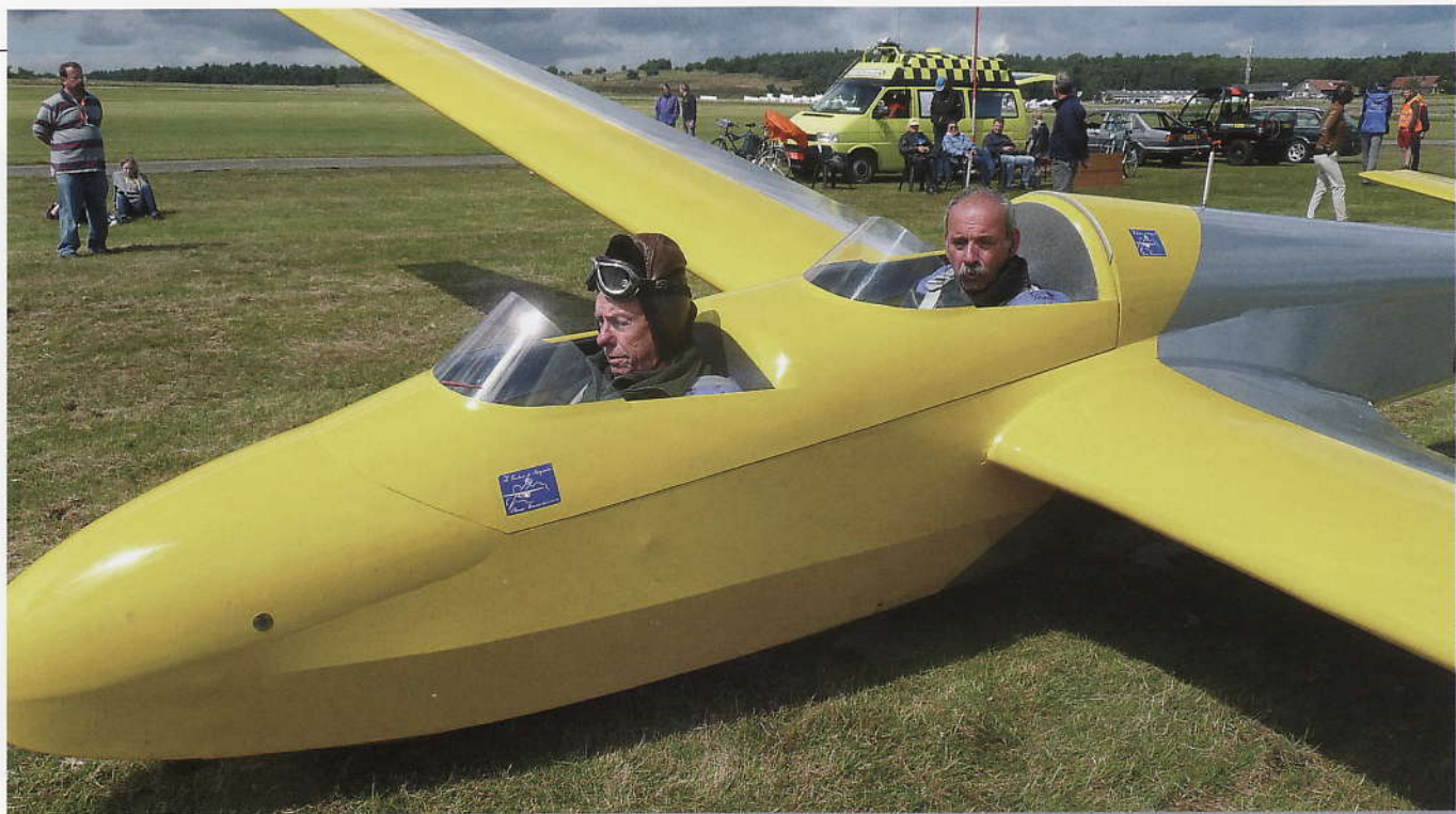
Dettaglio della trasformazione cabrio applicata sullo Schleicher ASK-13. Ovviamente si può reinstallare la capottina originale al posto di questa, modificata.
