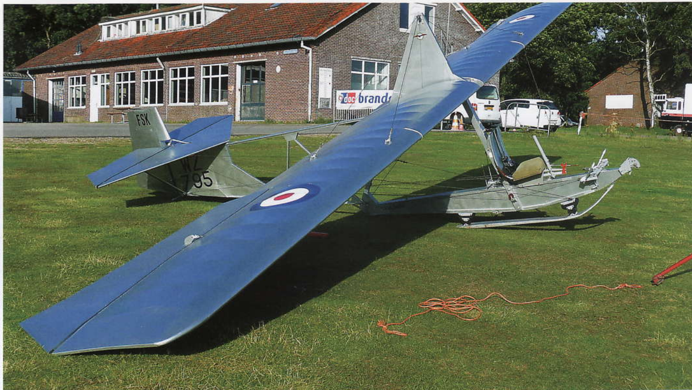
Slingsby Grasshopper: derivato dal classico libratore tedesco SG 38 Schulgleiter, ma che usa la stessa ala dello Slingsby T-7 Kirby. Economico e di facile smontaggio, è rimasto in uso d'addestramento basico militare dal 1952 fino alla fine degli Anni '80
